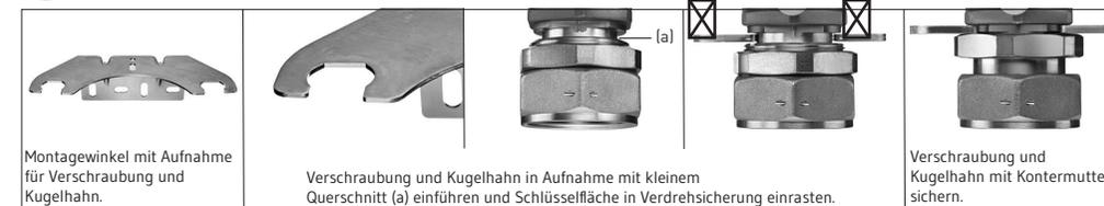
Montagewinkel mit Aufnahme für Verschraubung und Kugelhahn.
