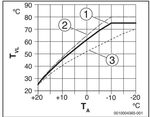
Bild 18 Einstellung der Heizkurve für Heizkörper
