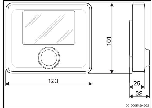
Bild 4 Abmessungen in mm
