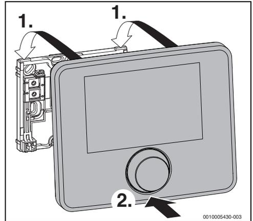
Bild 8 Bedieneinheit einhängen
