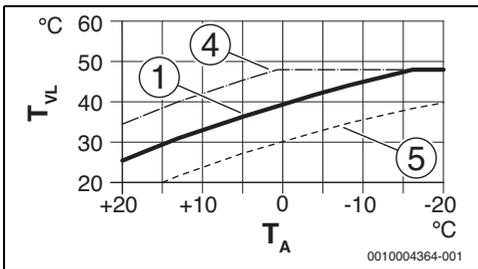
Bild 17 Einstellung der Heizkurve für Fußbodenheizung
