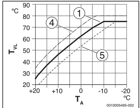
Bild 19 Einstellung der Heizkurve für Heizkörper
