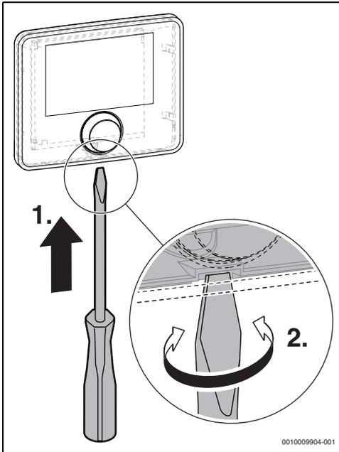
Bild 10 Abdeckung an der Rückseite der Bedieneinheit lösen
