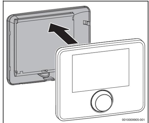
Bild 11 Abdeckung von der Rückseite der Bedieneinheit entfernen
