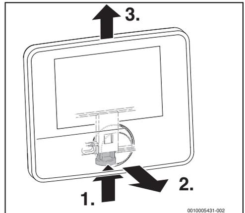
Bild 9 Bedieneinheit abnehmen
