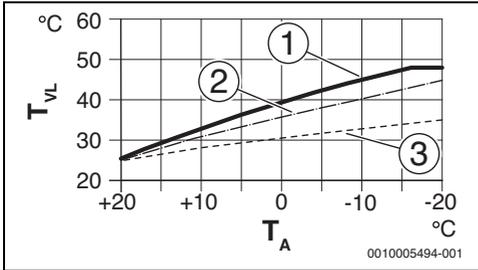
Bild 16 Einstellung der Heizkurve für Fußbodenheizung
