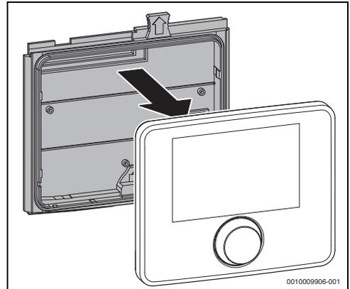
Bild 12 Einbaurahmen an der Rückseite der Bedieneinheit anbringen
