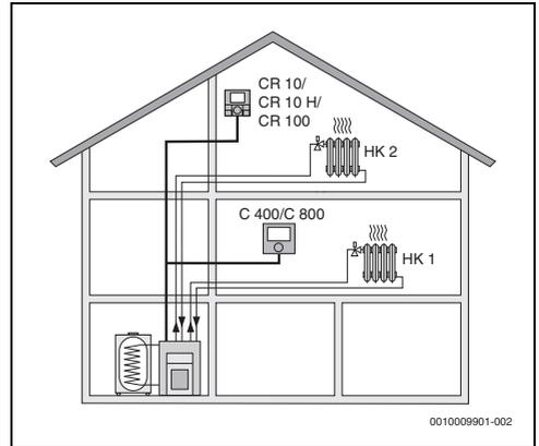
Bild 2 CR 10/CR 10 H/CR 100 als Fernbedienung für den zweiten Heizkreis (HK 2) und C 400/C 800 als Regler für den ersten Heizkreis (HK 1)
