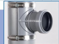
Einfache Montage: Loch bohren Ø 48 mm, entgraten, Sattel-Abzweig aufsetzen, Schlauchschellen leicht andrehen. **FERTIG!**
