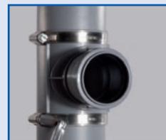
Einfache Installation: Loch bohren, entgraten, Sattel-Abzweig aufsetzen, Schlauchschellen anbringen und leicht andrehen. FERTIG!
