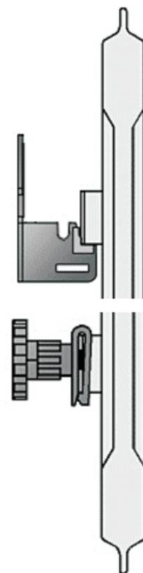
D: "Bei der Montage von Heizkörpern ist zu beachten, dass die Befestigung von Heizkörpern so dimensioniert wird, dass sie für die bestimmungsgemäße Verwendung und vorhersehbarer Fehlanwendung geeignet ist. Hierbei sind insbesondere die Verbindung mit dem Baukörper sowie dessen Beschaffenheit, die Geeignetheit des Montagezubehöres und die möglichen Belastungen nach erfolgter Montage zu prüfen.“
