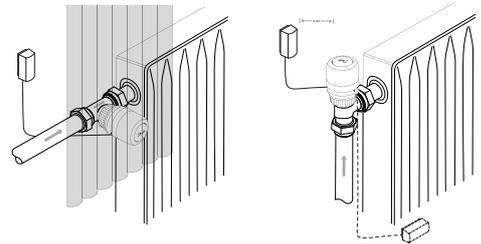
Der Fernfühler muss an der Wand, mit Abstand zu Vorhängen befestigt, oder an der Sockelleiste unter dem Heizkörper montiert werden, wenn diese frei von Aufputzrohren ist.
